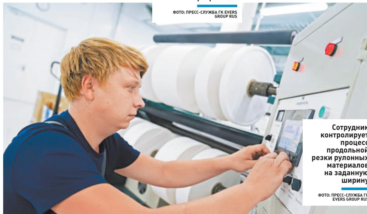
Сотрудник контролирует процесс продольной резки рулонных материалов на заданную ширину
